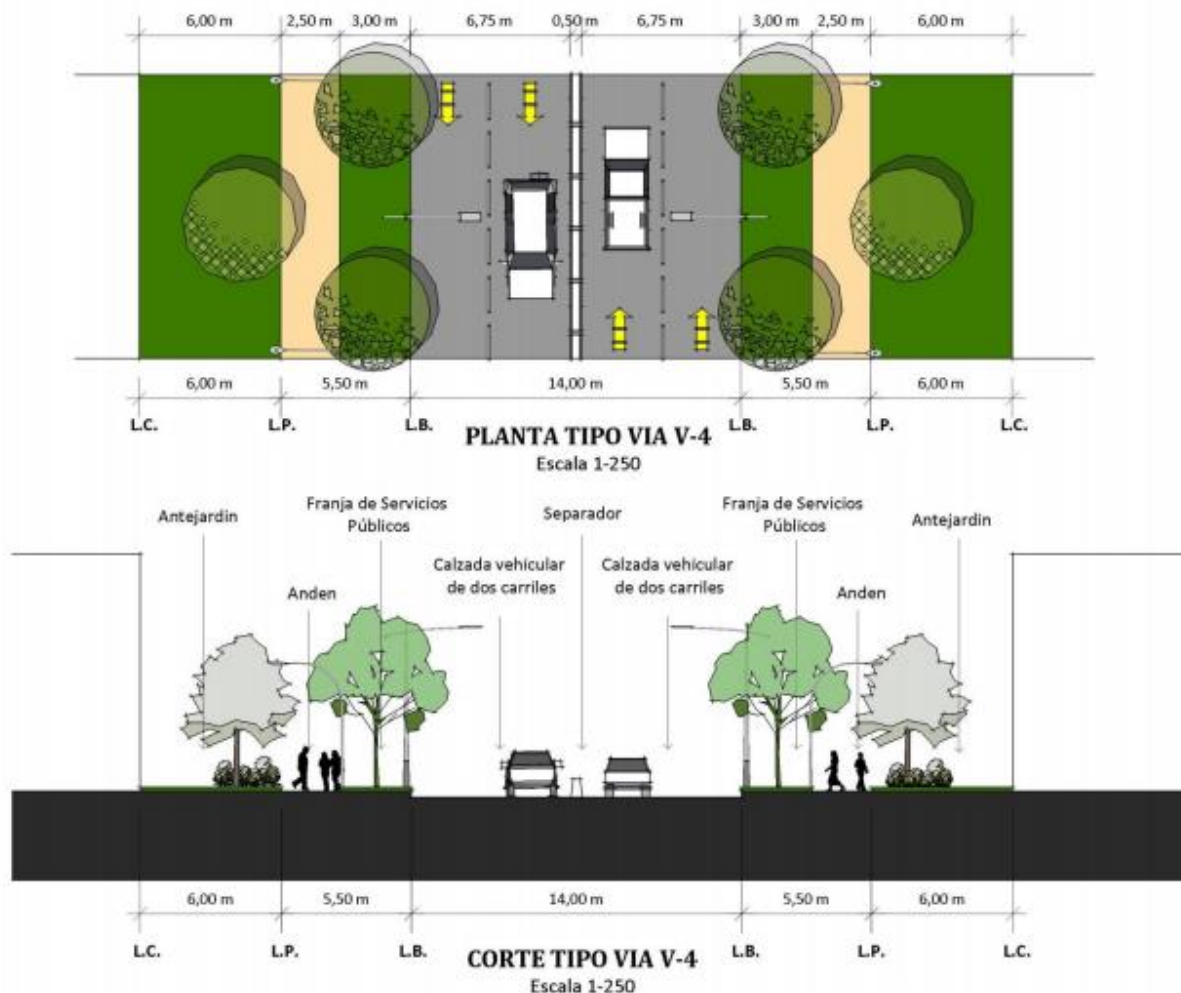
Ilustración 10 Sección típica de una vía con perfil tipo V4
